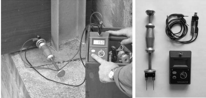
Figura 1.5: L'umidità del legno si può misurare in cantiere per mezzo degli igrometri elettrici, apparecchi che misurano la resistenza elettrica fra due elettrodi (chiodi) infissi nel legno la quale è correlata con l'umidità del legno.
