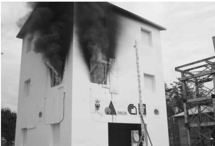
Figura 2.39: Un momento della prova durante la fase di incendio pienamente sviluppato (fonte [www.progettosofie.it](http://www.progettosofie.it)).
