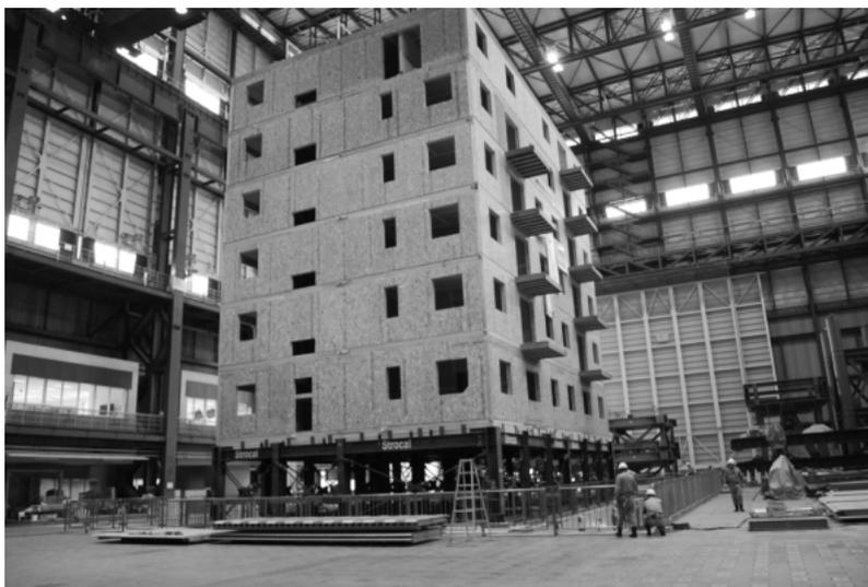
Figura 2.38: Edificio di 6 piani a struttura di legno sottoposto a prove sismiche presso la tavola vibrante E-Defence a Miki, Kobe, Giappone (Luglio 2009, per gentile concessione del Prof. J. Van De Lindt). L'edificio è stato sottoposto più volte alla registrazione del terremoto di Northridge (California 1994) scalato fino ad una accelerazione massima di 0,88 g, corrispondente ad un terremoto con una probabilità di accadimento del 2% in 50 anni.
