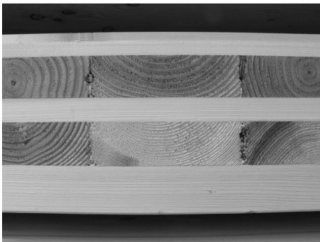
Figura 1.11: Sezione di pannello di XLam a 5 strati.
